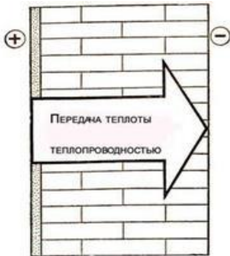
Сурет: 1 жылу өткізгіштік бойынша кірпіш қабырға арқылы жылу беру
